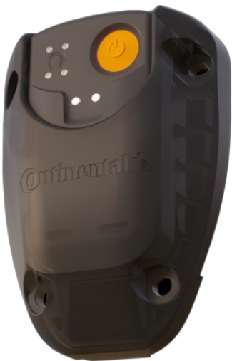
Elektronikeinheit mit Beschleunigungssensoren
